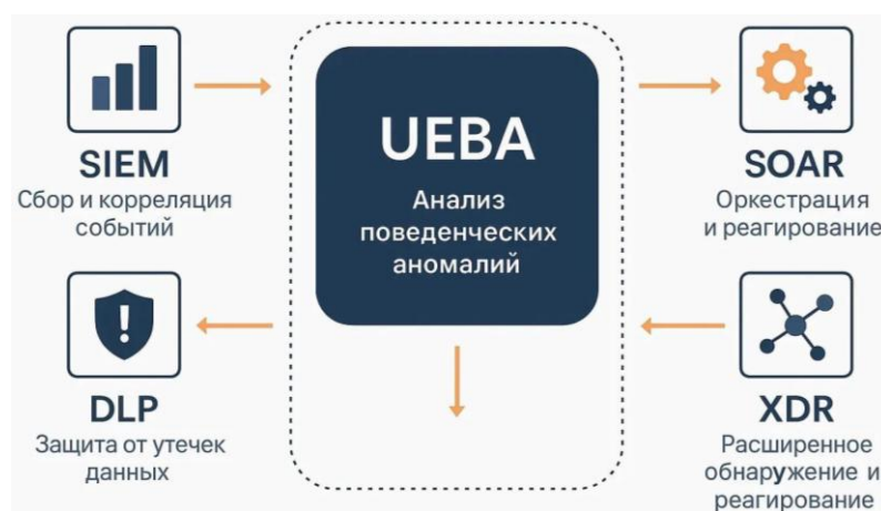
Рисунок 2 Интеграция UEBA с SIEM, SOAR, DLP и XDR в системе управления кибербезопасностью
